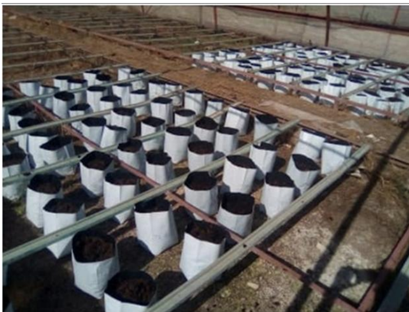
Figura 4. Bolsas hidropónicas (color blanco/negro cal. 600, de 35 x 35 cm), con una capacidad de 10 L de volumen utilizadas en el experimento.
