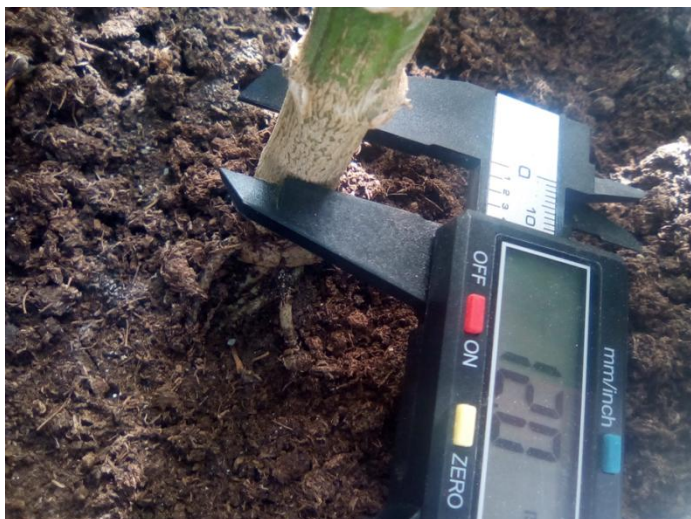
Figura 7. Medición de la variable diámetro de tallo (DT) con el vernier digital (Stereon®).
